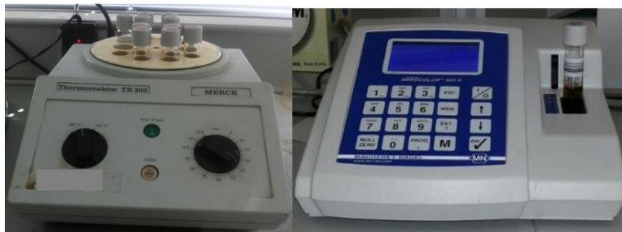
**Figura 3.13 Equipos utilizados para el análisis con los kits. De izquierda a derecha: digestor y espectrofotómetro Nanocolor**
