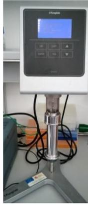
**Figura 3.12** Equipo utilizado para la determinación de la viscosidad
