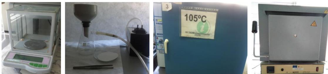
**Figura 3.11 Equipos empleados para el análisis de MLSS y MLVSS: (de izquierda a derecha) balanza, dispositivo de filtración, estufa y mufla**
