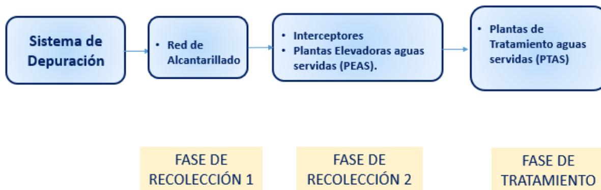
Figura 8 Esquema de componentes y fases de operación del Sistema de Depuración.
