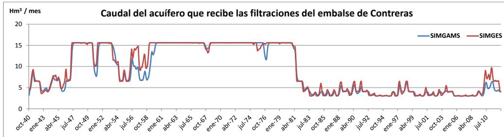
Figura 74. Caudal del acuífero que recibe las filtraciones del embalse de Contreras. SIMGAMS vs SIMGES
