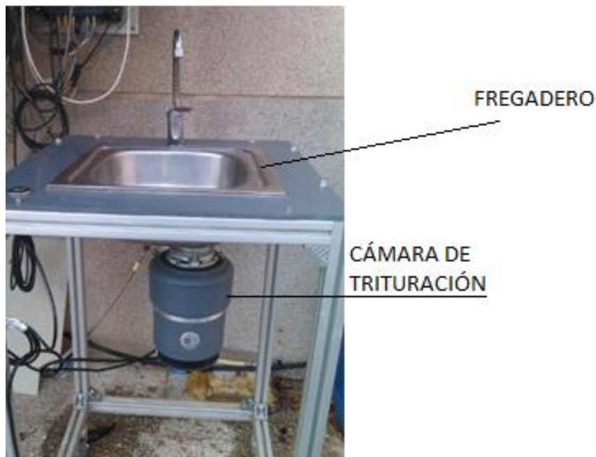
Figura 3. 1. Montaje para la trituración previa de la FORSU.
