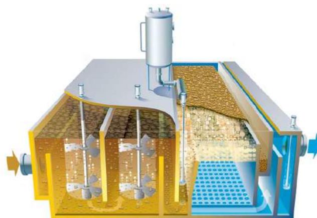
Figura 8: Sistema de Flotación por Aire Disuelto (AquaDAF® Degremont Technologies – SUEZ)
