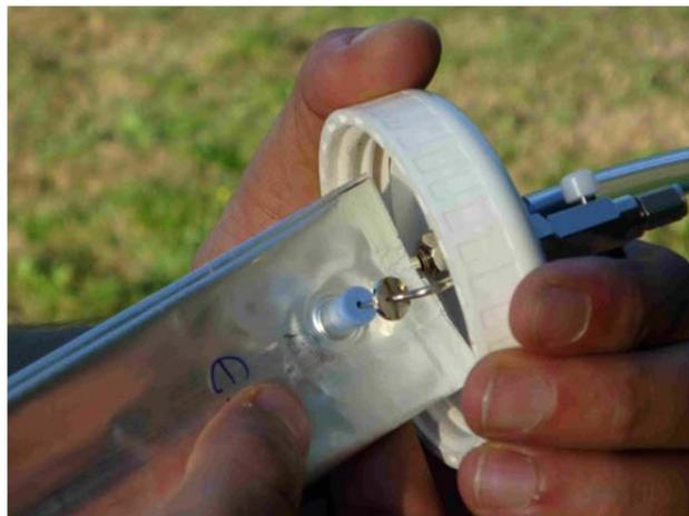
Foto 2-3: Colocación de la bolsa de gases.
